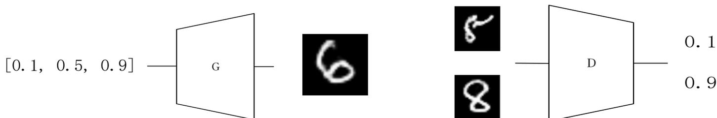
1. 固定  $G$ ，训练  $k$  次  $D$ ，使得输入真实手写数字时， $D$  输出高分；输入  $G$  生成的手写数字时， $D$  输出低分；
